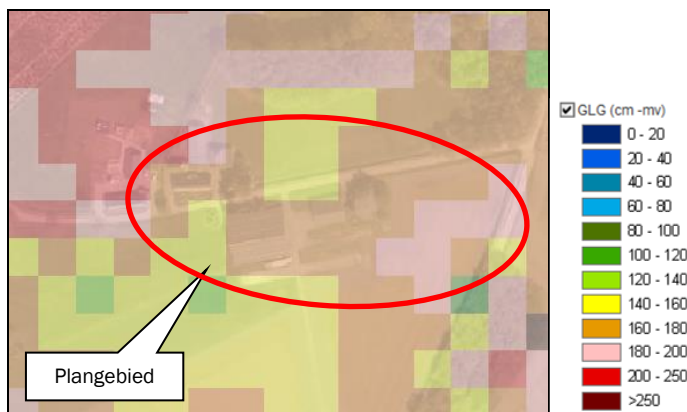
Figuur 25: Gemiddelde laagste grondwaterstand (GLG) (bron: Bodematlas, Noord-Brabant)
